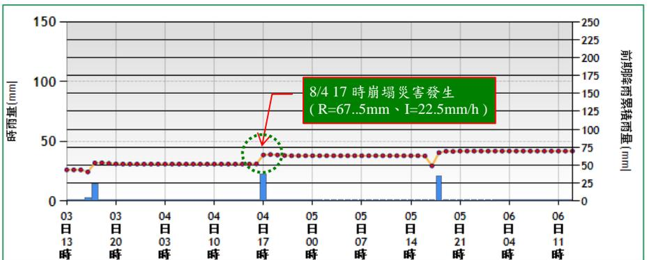
參考雨量站：內埔(C1M490) 土石流警戒基準值：350mm
