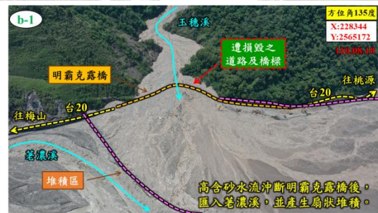
連日豪雨造成玉穗溪大規模崩塌面積約 49 公頃，河岸崩塌面積約 29 公頃。
