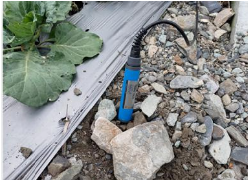
圖 2-4 土壤含水量計垂直架設示範照片
