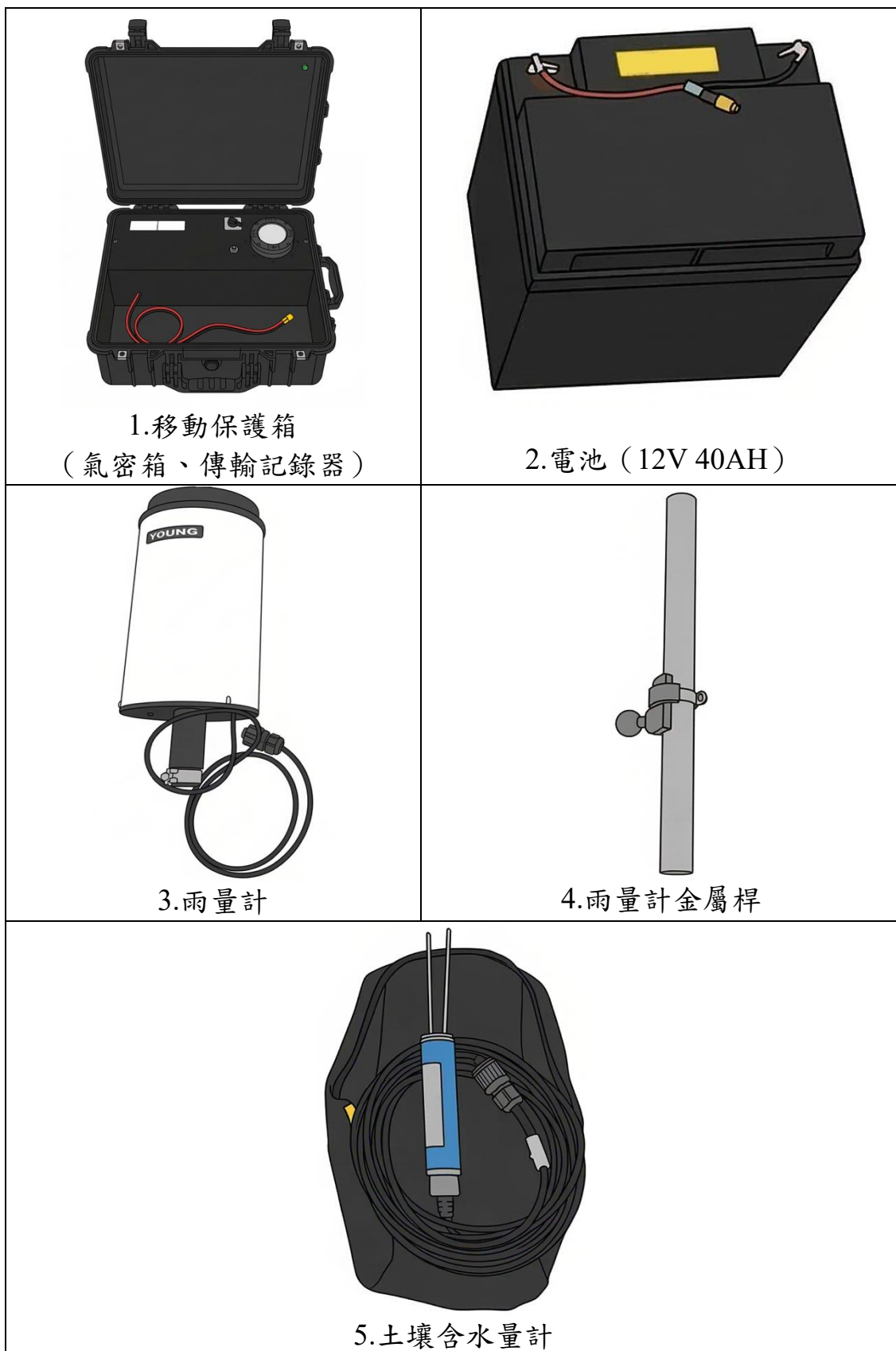
圖 1-1 機動觀測站 (RS) 設備包含: 1. 移動保護箱 (氣密箱、傳輸記錄器)、2.電池、3.雨量計、4.雨量計金屬桿、5.土壤含水量計
