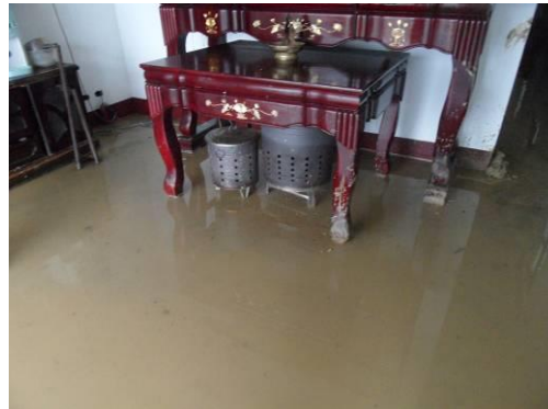
溢淹： 河道排洪斷面不足，溢淹至路面及保全民宅 【100 年南瑪都颱風屏東縣恆春鎮潭子路洪水災害】
